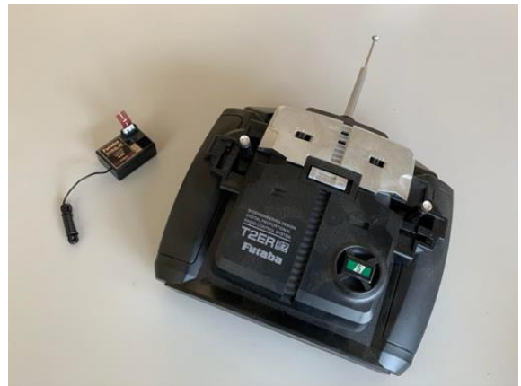
市售 3 通道 27MHz 板型遙控收發器
